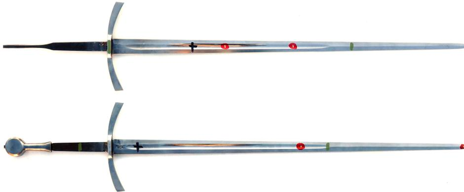
Abbildung 16: Vorderer und hinterer Drehpunkt (rot) desselben Schwerts ohne und mit Knauf. Schwerpunkt: Schwarzes +. Vorderer und hinterer Ansetzpunkt sind nicht eigens markiert, dafür aber die Schwingungsknoten (grün).
